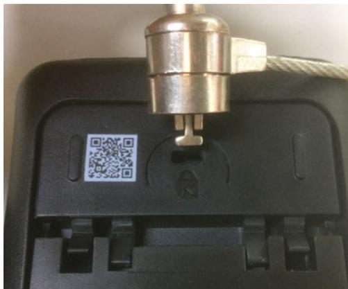
En la parte posterior del osciloscopio se reserva una cerradura de seguridad. Usuarios
