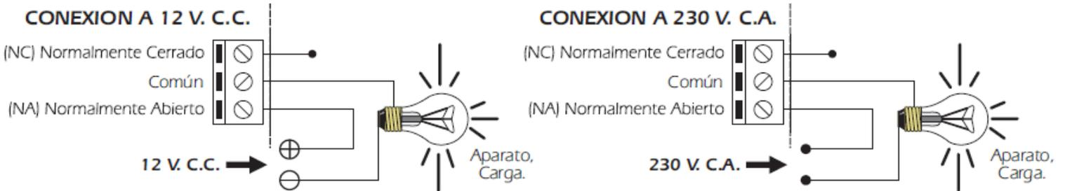
**CONSIDERACIONES SOBRE LA SALIDA.** Durante el funcionamiento del circuito, y según sea su carga, podrá producirse una fluctuación o un incorrecto funcionamiento de la salida. Si esto ocurre, instale un circuito antichispas entre los dos contactos del relé utilizados en la conexión.
