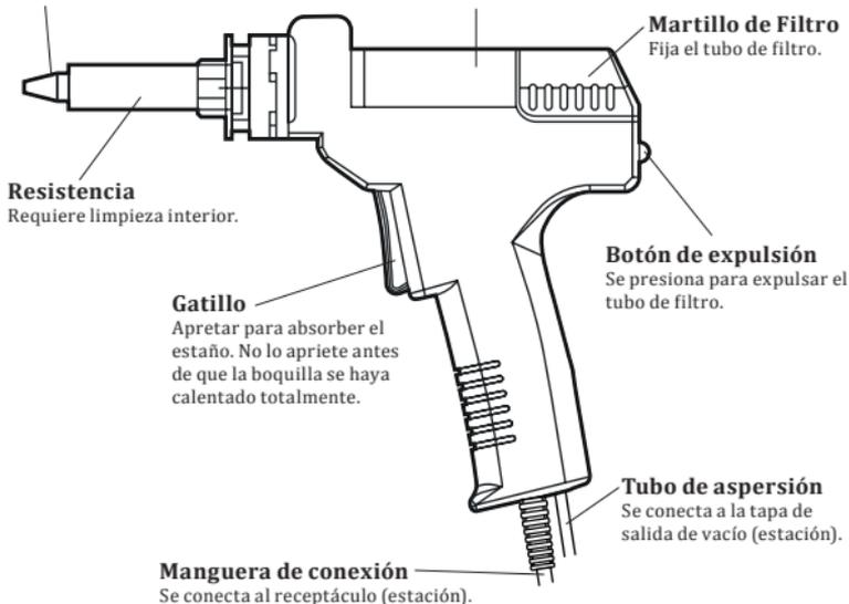
**ADVERTENCIA:** Dado que el estaño puede alcanzar temperaturas muy altas, por favor trabaje con cuidado. Excepto cuando realice la limpieza de la boquilla y de la resistencia, apague siempre el interruptor de encendido y desconecte el cable de la corriente antes de realizar cualquier tarea de mantenimiento.
