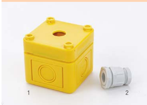
Caja para interruptor de paro de emergencia de orificio de montaje 16mm, 65mm (ancho) x 65mm (alto) x 57mm (profund.) y prensaestopas M16
