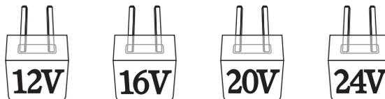
13 Chip insertables para determinar la salida de voltaje
